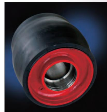
ポンピングチューブを押し潰すのに最適な形状のゴムローラを搭載しました。これによりホッパからの吸引力がアップしチューブ寿命も大幅に伸びました。
