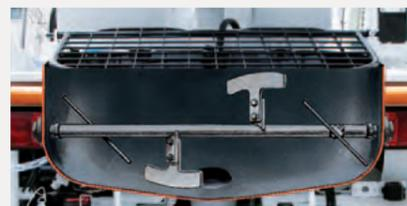
生コンが吸入口に集まりやすい舟底ホッパ。吸込み効率がよく、残コンが少なく、洗浄も簡単に行えます。
