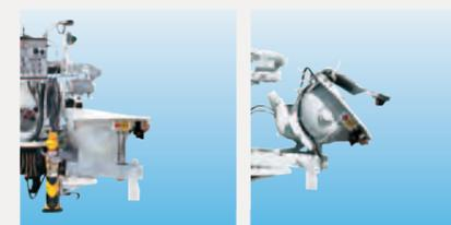
生コンの吸込効果が良く、残コンが少なく、洗浄も簡単な球形ホッパ。ポンピングチューブの交換時に、作業スペースを大きく確保し、交換時間の短縮を図るチルト機能を装備させました。
