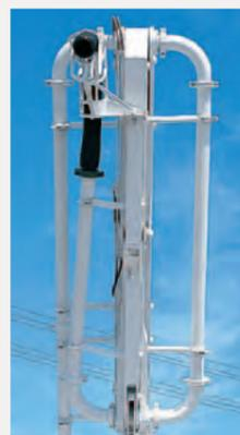
ブーム配管には摩耗検知穴付きロングエルボパイプを使用。生コンクリートの流動性が向上し、配管抵抗が少なくなりました。ブーム配管(パイプ・エルボ・ジョイント)は消耗品です。定期的に点検、交換を推奨します。
