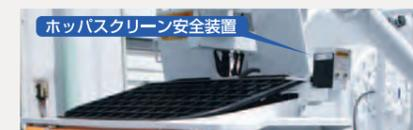
ホッパスクリーン安全装置を標準装備しました。スクリーンを開くとホッパブレードの回転を停止させます。
