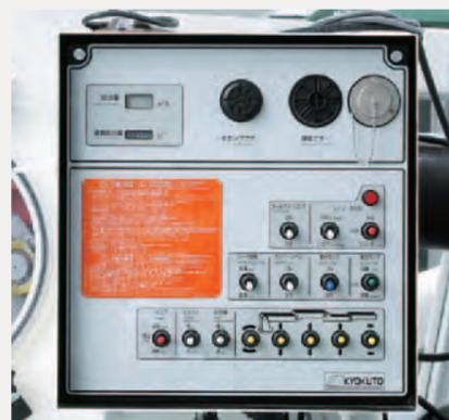
操作しやすく、ホッパ内の生コンクリートの状況が見やすい位置に設けています。すべてスイッチ操作で圧送作業が簡単、確実に行え、オペレーターとマシンの一体作業を実現します。作業に応じて、高速/低速の切換えができます。また、打設量の判定、チューブ交換や保守点検の目安となる積算式ロータ回転計をデジタル化させて、パネルに組み込みました。
